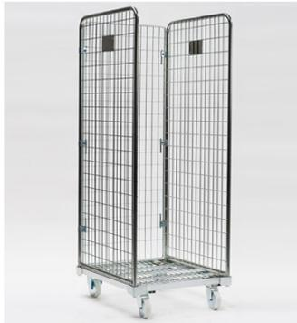
Découvrez le **roll conteneur 3 côtés d'une hauteur de 1710 mm**, disposant de petites mailles, idéales pour le transport de petites pièces, d'archives ou encore de marchandises de quincaillerie. Sa structure électrozinguée repose sur un socle de métal très résistant, pouvant accueillir une charge maximale de 500 kg. Il peut alors entreposer plusieurs centaines de kilos de marchandises dans une zone de stockage
