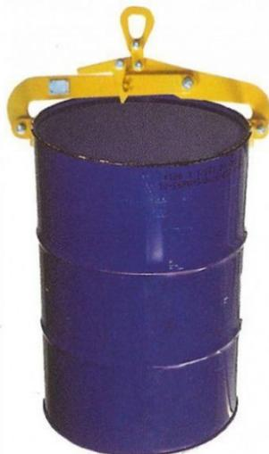
Cette pince de levage est destinée à transporter des fûts métalliques fermés. Grâce à son ossature en acier mécano-soudé, vous pouvez soulever des fûts de **550 kg**. Le serrage de la pince de levage est proportionnel à la charge du fût. Ce système permet d'éviter de laisser échapper le fût qui serait éventuellement trop lourd.
