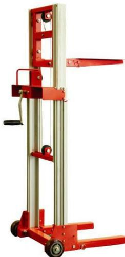
Supportant 80 kilos de charge, ce **mini gerbeur manuel** a été conçu pour garantir une sécurité optimale ! Ce gerbeur manuel protège votre corps de TMS (Trouble Musculo-Squelettique) et peut élever une marchandise jusqu'à 1250 mm de hauteur. Pour effectuer tous vos petits [travaux de manutention](#) ou de stockage, misez sur ce produit véritablement indispensable ! Rendez-vous sur [rolléco.fr](http://rolléco.fr).
