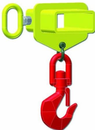
Le **crochet de levage** destiné aux chariots élévateurs est fabriqué en acier mécano-soudé robuste. Il se resserre manuellement sur la fourche du chariot grâce à une vis disposée sur le côté. Le crochet de levage se fixe sur une fourche d'une dimension de 120 x 50 mm. Il vous permettra de soulever plus facilement des charges lourdes de 350 kg maximum, et notamment des pinces à fûts.
