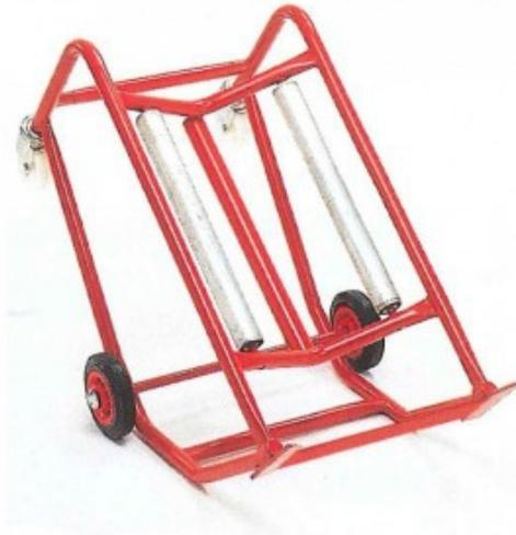
Le **chariot porte-fût**, de la marque Manuest, possède une structure robuste avec un tube en acier soudé. Grâce aux 4 galets de pivotement en polyamide, le fût peut se tourner sur lui-même, facilitant ainsi la vidange. Le chariot porte-fût est doté de deux roulettes fixes, et de deux roulettes pivotantes. Ainsi, vous n'aurez aucune difficulté à le déplacer selon vos besoins.
