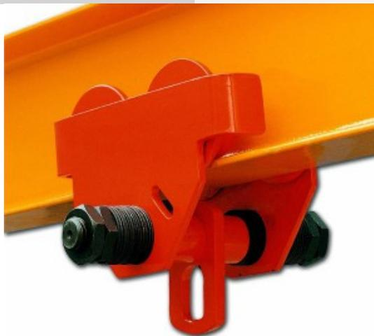
Fabriqués en acier, ces [chariots porte-palans manuels](#) sont résolument robustes et résistants. Ils sont équipés de 4 galets pour pouvoir se glisser facilement ! L'écartement de ces chariots se fait directement par un système d'empilage de rondelles. De plus, ces **chariots porte-palans** sont conformes aux normes CE et pourront soutenir jusqu'à 10 tonnes de charge maximale. Rendez-vous dès maintenant sur [rolleco.fr](http://rolleco.fr).
