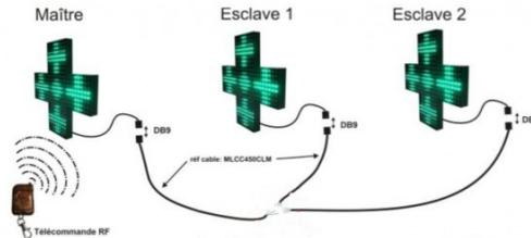
Il s'adapte sur chaque croix et permet de synchroniser 3 enseignes entre elles. Permettant ainsi de doubler les faces de l'enseigne ou d'en afficher plusieurs à différents endroit du bâtiment. Sa prise synchronisation doit obligatoirement être à l'abri des intempéries : dans un boîtier de dérivation par exemple.
